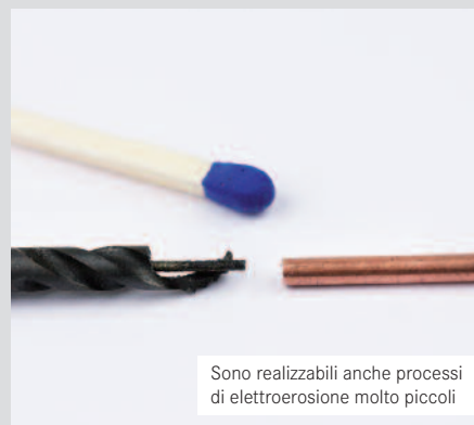
Elettroerosione di una vite rotta con un elettrodo cavo in rame quadrangolare
