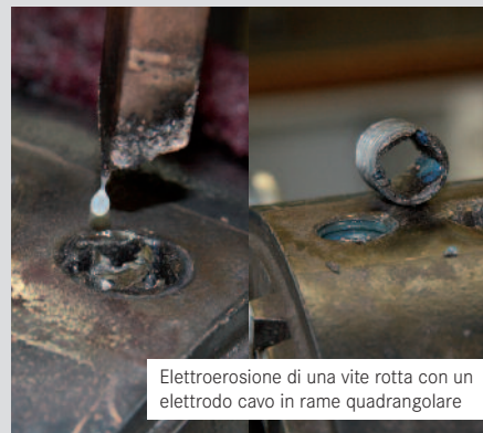
Resti di erosione di una punta rotta dopo il processo di elettroerosione con un elettrodo di lunghezza 500 mm
