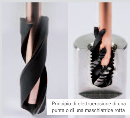
Resti di erosione di una punta rotta dopo il processo di elettroerosione con un elettrodo di lunghezza 500 mm
