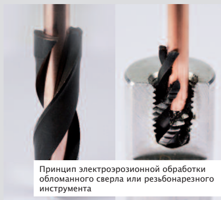
Остатки обломанного сверла после электроэрозионной обработки с помощью электрода спецдлины 500 мм
