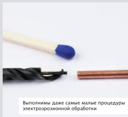
Принцип электроэрозионной обработки обломанного сверла или резбонарезного инструмента
