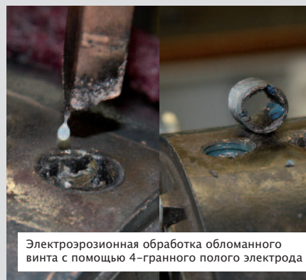
Остатки обломанного сверла после электроэрозионной обработки с помощью электрода спецдлины 500 мм
